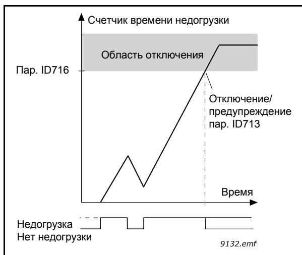
Рис. 82. Функция счетчика времени недогрузки, ИД 713 = Р3.9.4.1 Отказ из-за недогрузки, ИД 716 = Р3.9.4.4 Защита от недогрузки: предел времени
